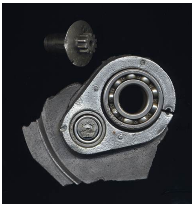
Una de las piezas halladas, correspondiente a los engranajes de una magneto.
